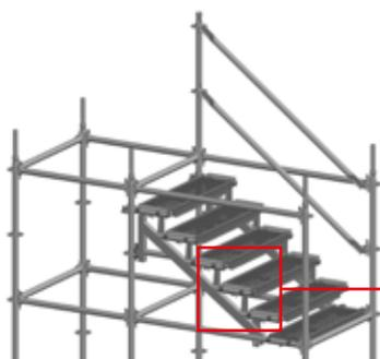
Fixer les planchers Contur sur les limons avec les plaques bloqueuses et leurs goupilles. Les plaques et les goupilles sont livrés avec les limons.
