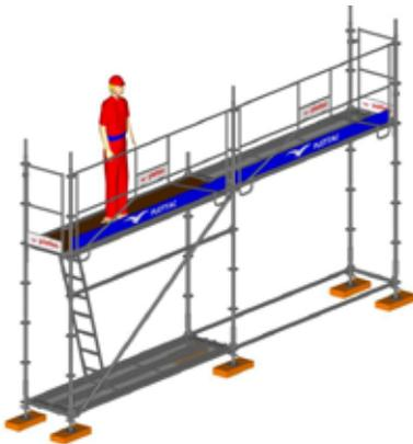
12. Ancragé à 4 mètres et montage ainsi de suite jusqu'au dernier niveau.
